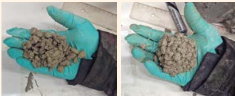
BCR à l'état frais : (a) matériau trop sec ; (b) matériau de bonne consistance.
