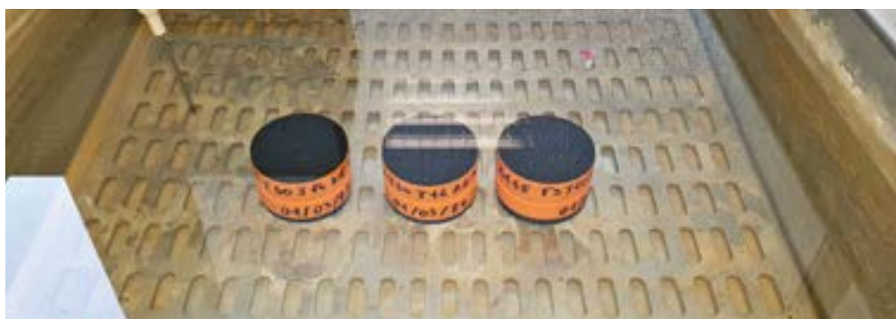
Éprouvettes 50x50 mm en étuis fermés étanches dans un bain thermostaté.
