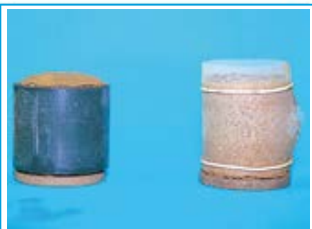
—Figure 3— Essai d'aptitude du sol au traitement selon la norme NF P94-100.
