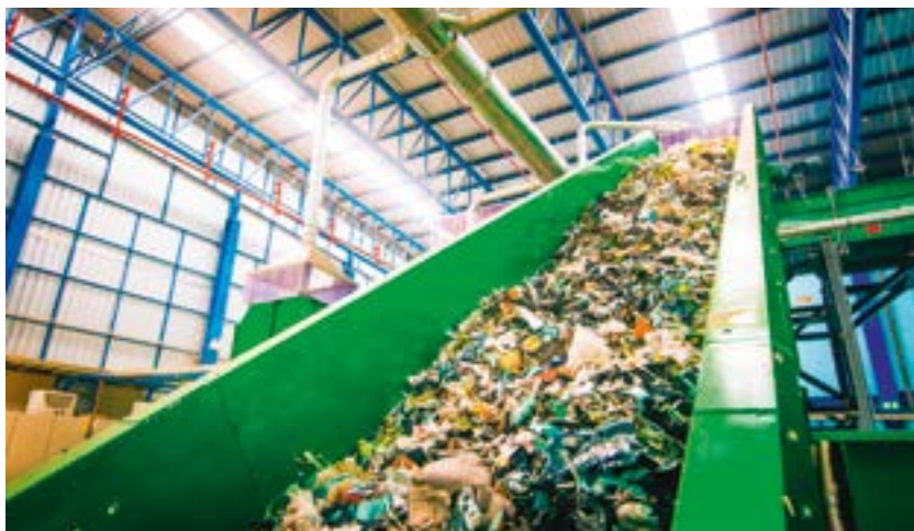
—Photo 3— Combustibles alternatifs utilisés en cimenterie.
