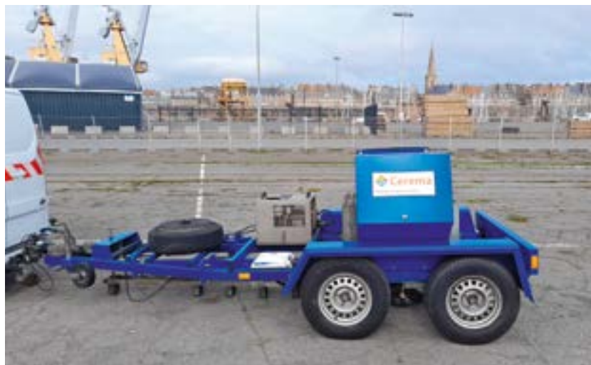
—Photo 3— Déflectomètre à masse tombante ou FWD.
