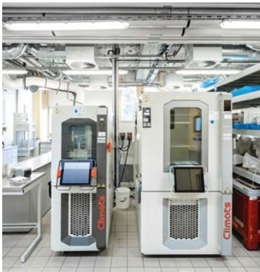
–Photo 2– Enceintes thermorégulées utilisées dans le cadre de l'étude.
